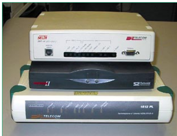
Figura 1 Alcune terminazioni di utente HDSL utilizzate da Telecom Italia.
