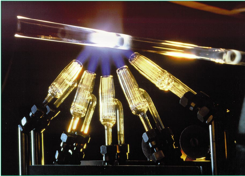
Processo di deposizione di una fibra ottica.
