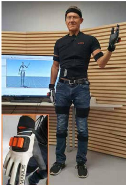
capture, in cui gli "attori" indossano tute con sensoristica integrata: Xsens [21] rappresenta un esempio di tuta indossabile in grado di leggere e restituire i movimenti del corpo e delle mani (Fig.2).
