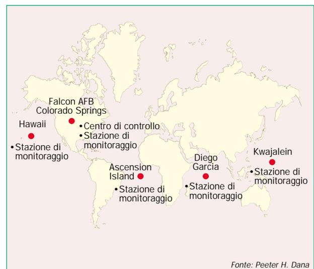
**Figura 2** Le stazioni di terra del sistema GPS.
