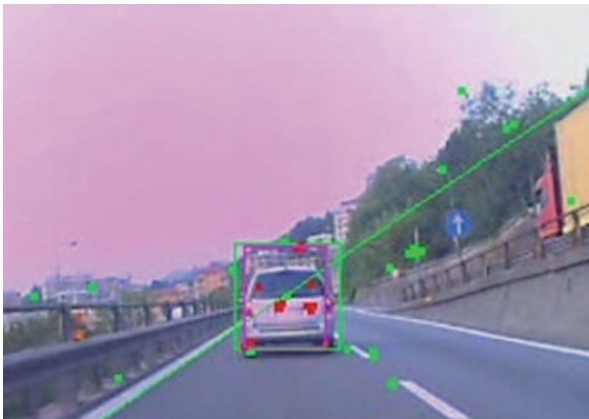
Figura 5 - Esempio estrazione veicoli tramite il metodo KLT
