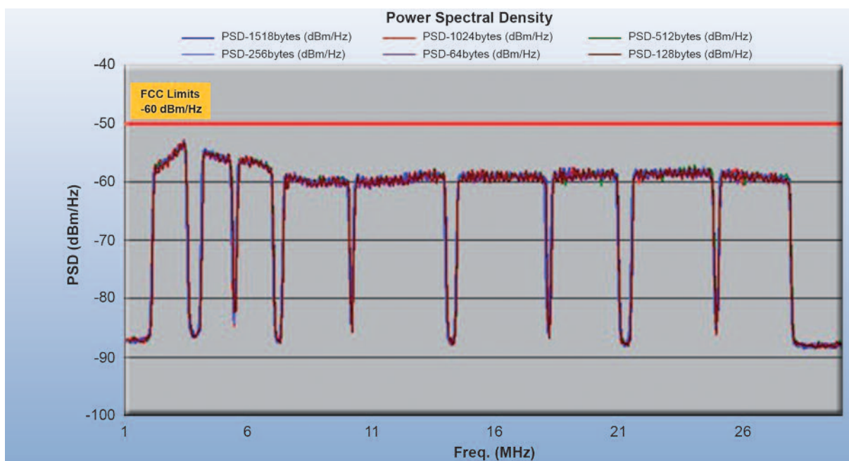
Figura 2 - Esempio di PSD misurata in laboratorio su apparati PLT
