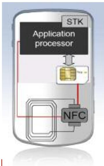
Figura 4 - Architettura NFC definita da ETSI SCP
