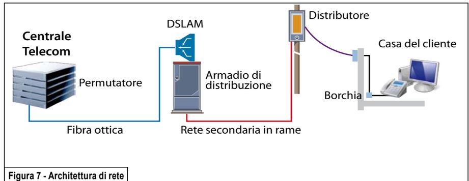
Figura 7 - Architettura di rete
