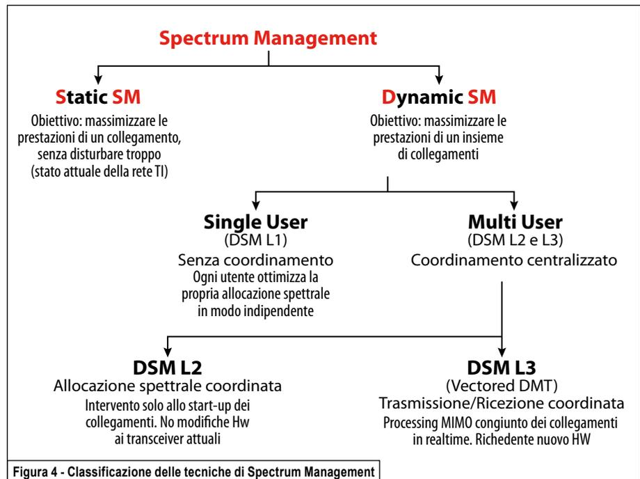
Figura 4 - Classificazione delle tecniche di Spectrum Management
