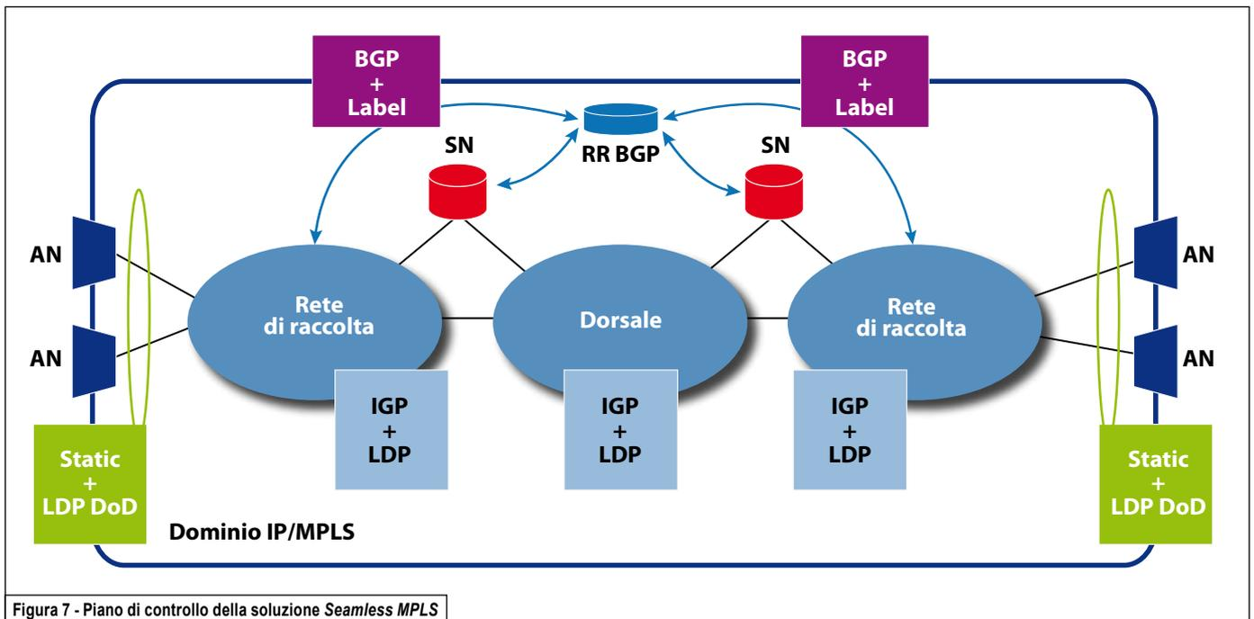
Figura 7 - Piano di controllo della soluzione *Seamless MPLS*
