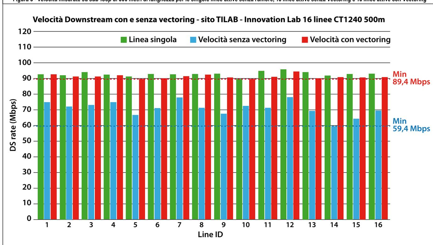
1 16 linee VDSL2, profilo 17a, maschera B8-8, su 500m di cavo CT1240-0.4 mm
