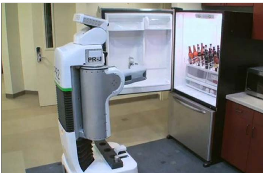
Figura 4 - Il robot PR2 della Willow Garage ci può prendere una birra dal frigo quando abbiamo sete, è una bella innovazione
