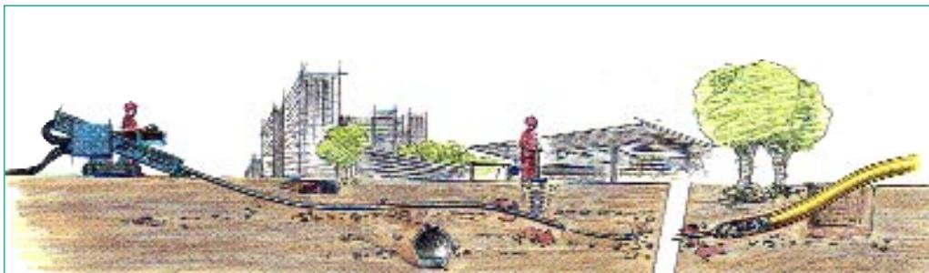
Figura 1 Perforazione orizzontale guidata (*directional drilling*).
