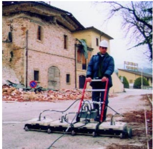
Analisi del terreno per verificare la stabilità del sottosuolo stradale a Sellano in provincia di Perugia dopo il terremoto del 1997.
