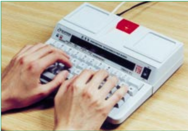
Figura 5 Apparato telefonico per sordomuti realizzato secondo lo standard V.18 nell'ambito del progetto MURST.
