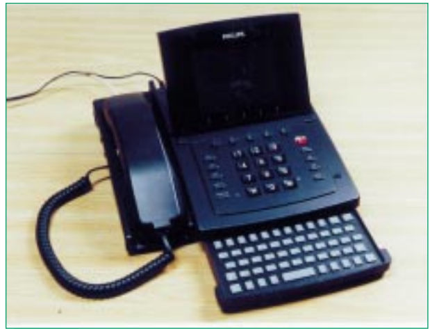
Figura 6 Dispositivo telefonico per sordomuti (modello Screen Phone P100) con protocollo di comunicazione V.18.
