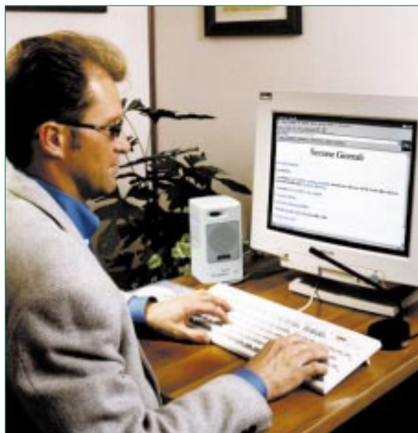
Figura 12 Postazione per utenti ciechi mediante PC per l'accesso e per la navigazione Internet con la riproduzione dei testi in sintesi vocale.
