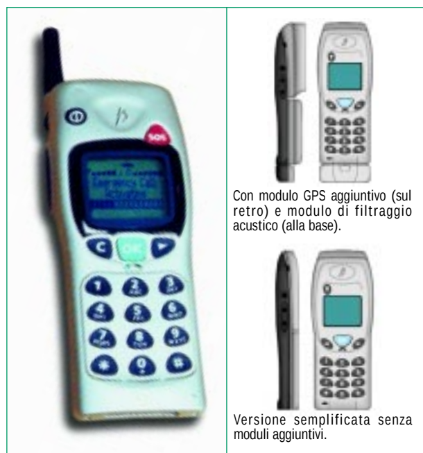
Figura 8 Prototipo del terminale mobile GSM MORE per la telelocalizzazione ed il telesoccorso di persone anziane o disabili.
