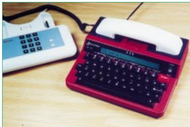
Figura 4 Apparecchio telefonico commerciale per sordomuti distribuito da Telecom Italia (modello ECOTRON fisso).
