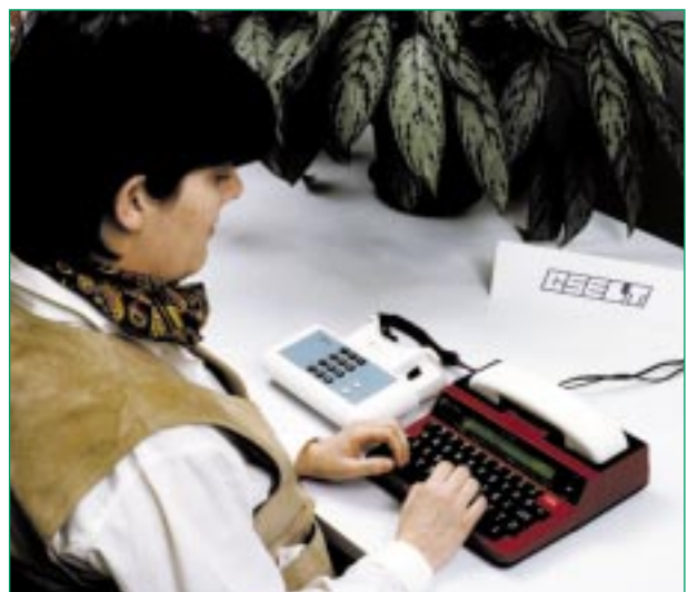
Figura 7 Servizio automatico di intermediazione tra un dispositivo telefonico per sordomuti e un telefono.
