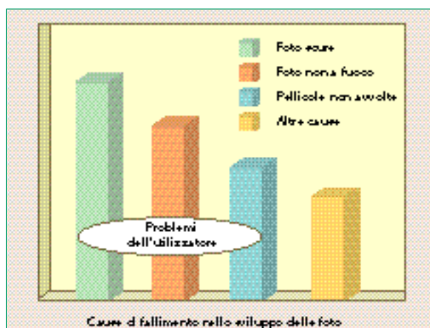
Figura 4 Modello della Konica per individuare le cause di fallimento nello sviluppo delle pellicole fotografiche.
