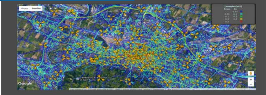
UE. In Figura 2 è riportato il livello di qualità radio per la rete LTE tramite la misura RSRQ. I valori migliori di RSRQ in dB che permettono le più alte prestazioni LTE a pacchetto sono in ordine dal verde al giallo ed infine al rosso.
