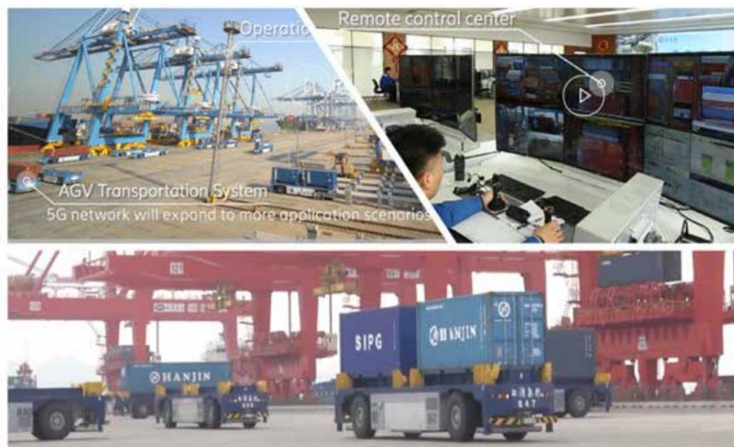
5 Porto Qingdao con veicoli a guida autonoma e centro di controllo remoto [sm2]
